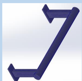
Rysunek 4. Model geometryczny drążka do podciągania z nałożoną siatką elementów skończonych
