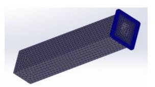
Rys. 4. Nałożona siatka na model. Fig. 4. Superimposed mesh on model.
