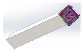
Rys. 5. Miejsce przyłożenia siły. Fig. 5. Place of force application.
