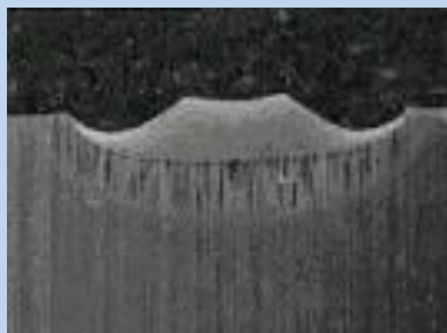
Rys. 1. Kształt i głębokość ściegu przetopienia stali na przekroju poprzecznym próbki, odpowiednio dla a) 1,2 kW; b) 2,3 kW.
